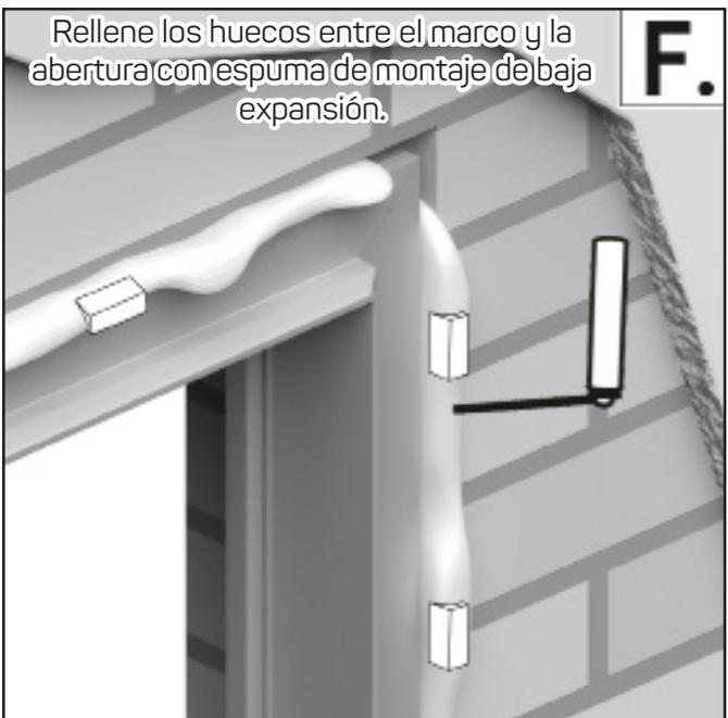
Rellene los huecos entre el marco y la abertura con espuma de montaje de baja expansión.
